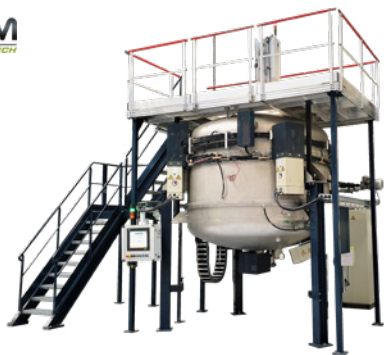
Four de cristallisation G8 de capacité 1300 kg
