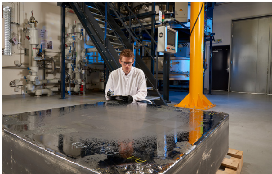
Lingot G8 de silicium Crystalmax® au premier plan, et four de cristallisation G8 de capacité 1500 kg à l'arrière plan (projet CRYSTALMEGA20)
