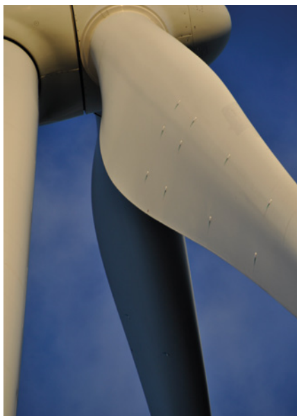
Pale d'éolienne équipée de penons électroniques
