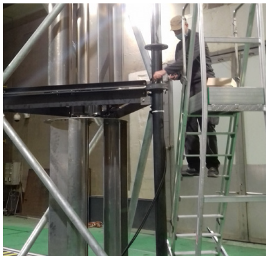
Montage de la Pylolienne pour des tests dans la soufflerie du Centre Scientifique et Technique du Bâtiment (CSTB)
