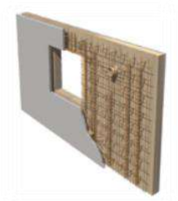
Mur à coffrage intégré isolant
