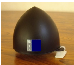
Exemple de dosimètre (appareil de mesure de la teneur en radon) © www.algade.com
