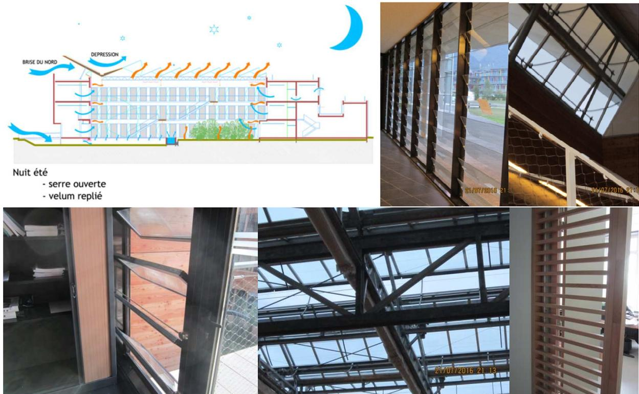
Figure 1 : Ventilation naturelle du bât. HELIOS en été – Savoie – de 20H00 à 13H00
