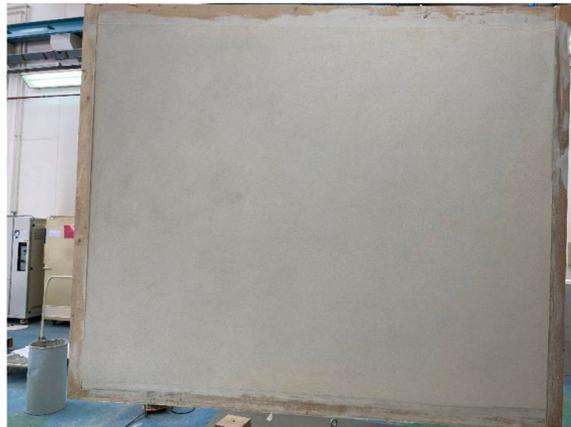
Figure 4. Maquette 1 avant cycles chaleur-pluie
