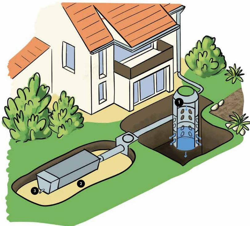
1 Puits d'infiltration de 1,5 m<sup>3</sup> utile avec surverse vers l'ouvrage de régulation (cf. fiche 2 - Les puits d'infiltration)
