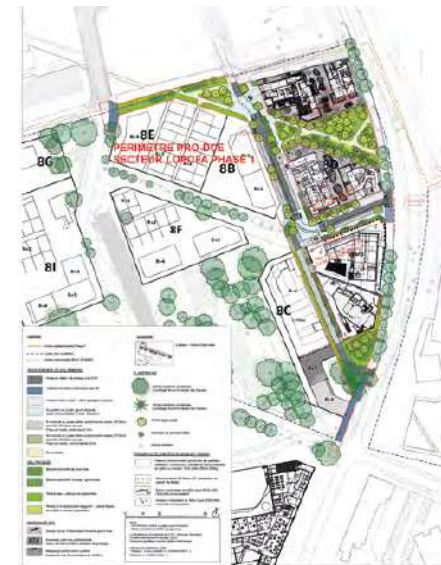
Plan PRO - un projet phasé – MOE des espaces publics – Tranche 1 : viabilisation des rues pour réalisation des lots bâtis (travaux en cours). Tranche 2 : aménagement du parc à venir.
