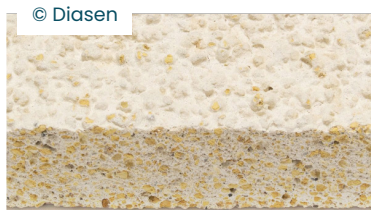
© Diasen Enduit Diathonite évolution – Diasen Chaux, liège et poudre de diatomé, c'est un enduit très poreux : l'air remplit les alvéoles et initie une grande action d'isolation thermique.
