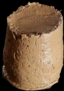
↑ Mortier de terre de Brézins : l'étalement est quasi nul.
