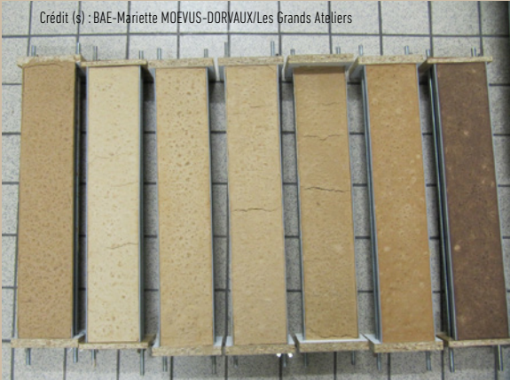
↑ Des essais préliminaires de retrait / fissuration ont permis de mettre au point la formulation du béton d'argile fluide pour la réalisation d'une dalle coulée.
