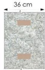
Béton dosé à 220 kg/m<sup>3</sup>
