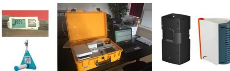
Figure : De gauche à droite : un capteur HoBo, un tube passif sur son support, le GC Companion et l'ordinateur associé, la balise NEMo et la station Fireflies. Source : Cerema
