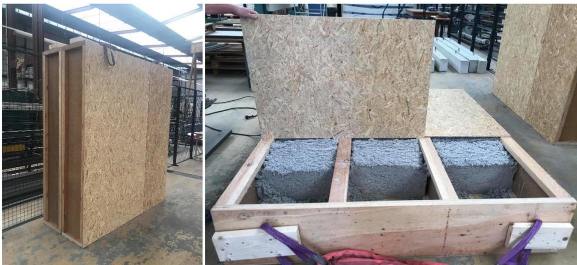
Figure : Caissons pré-fabriqués commandés à l'identique par l'équipe projet à l'entreprise ayant fabriqué les caissons du groupe scolaire. A droite: le caisson debout. A droite: le caisson ouvert. Source : photo de l'Université de Picardie
