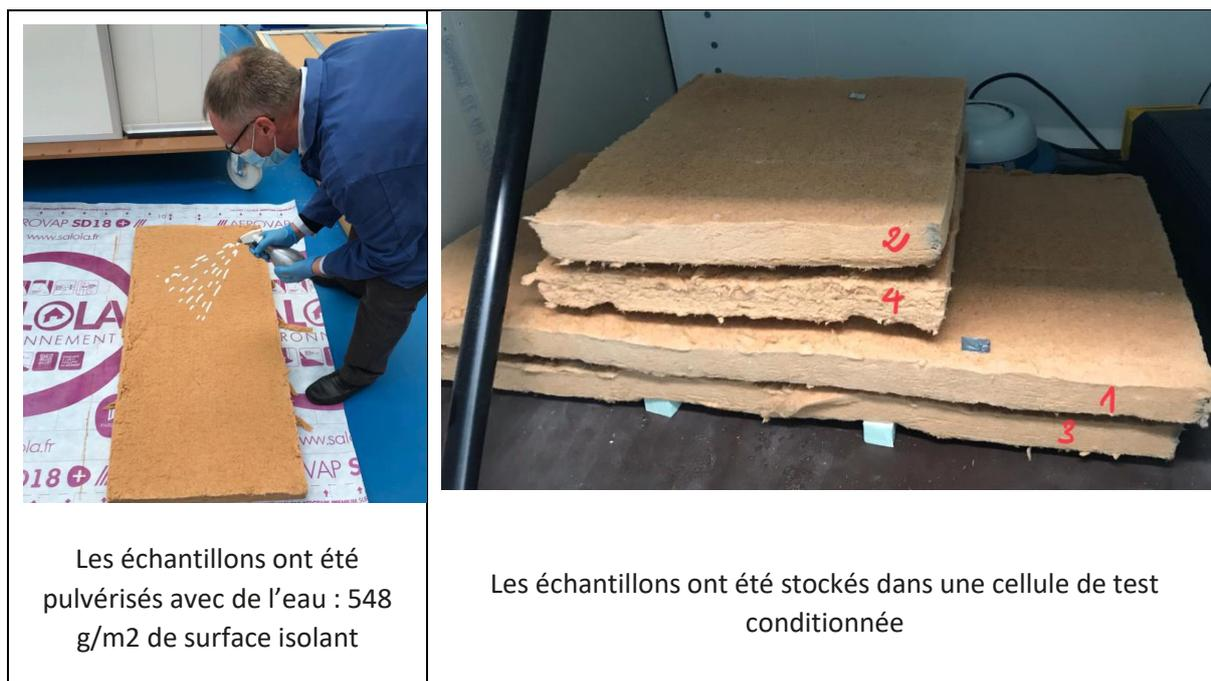
Figure : Mise en conditions de l'isolant. Source : Université de Picardie
