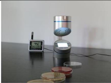
Figure 40: Mass 100 en condition d'échantillonnage.
