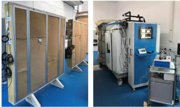
Figure 5: Mur de Moncheaux reproduits en laboratoire et les deux caissons climatiques. Source : Université de Picardie
