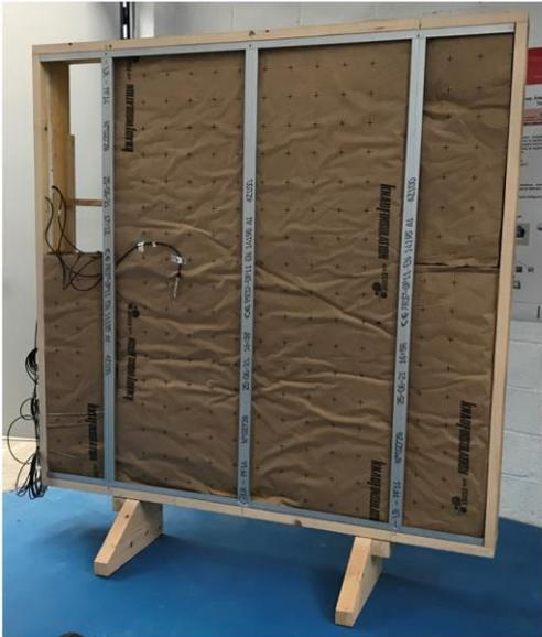
Figure : Reproduction du mur conventionnel. Source : Université de Picardie
