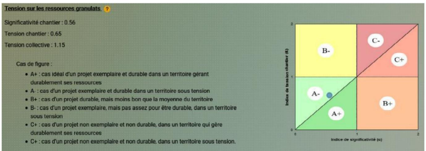
Figure 26. Mode de représentation des indicateurs tension chantier et tension collective, pour les ressources en granulat. Source : Bazzana et al. (2019).
