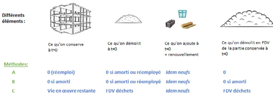
Schéma 29 : Comparaison des 3 méthodes d'évaluation des PCE en rénovation
