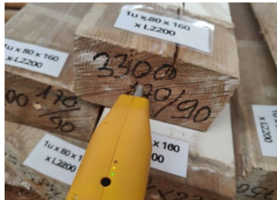
▲ Test de résistance mécanique du bois avec la sonde SilvaTest. Crédit photo : Pyrénées Charpente
