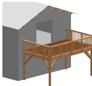
Structure poteau poutre (page 54)
