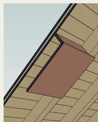
**Dans le cas d'une colonie importante, il est possible de poser un faux plancher (si présence de poutres porteuses) / bâche pour éviter la dégradation du plancher d'origine et permettre un nettoyage facile et régulier (une fois par an lorsque les chauves-souris ne sont pas présentes).**
