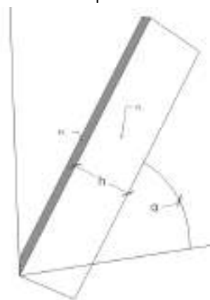
Inclinaison \alpha de l'axe longitudinal de l'élément par rapport à l'horizontale, face supérieure et face latérale
