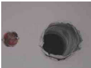
Défaut d'étanchéité au niveau du piquage sur Té-souche
