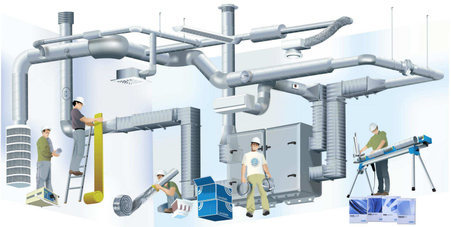
Figure 2-1 : Exemple de réseau aéraulique (source LINDAB)
