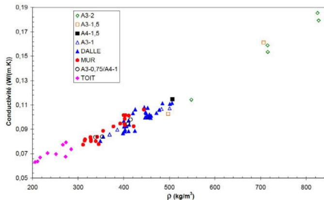
La conductivité thermique des bétons de chanvre varie en fonction de leur masse volumique entre 0.06 et 0.15 W/(m.K), en lien avec leur usage [Cerezo, 2005] (figure 3).
