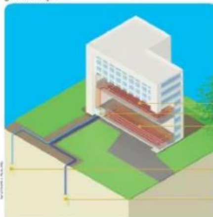
Schéma d'un bâtiment avec un doublet géothermique
