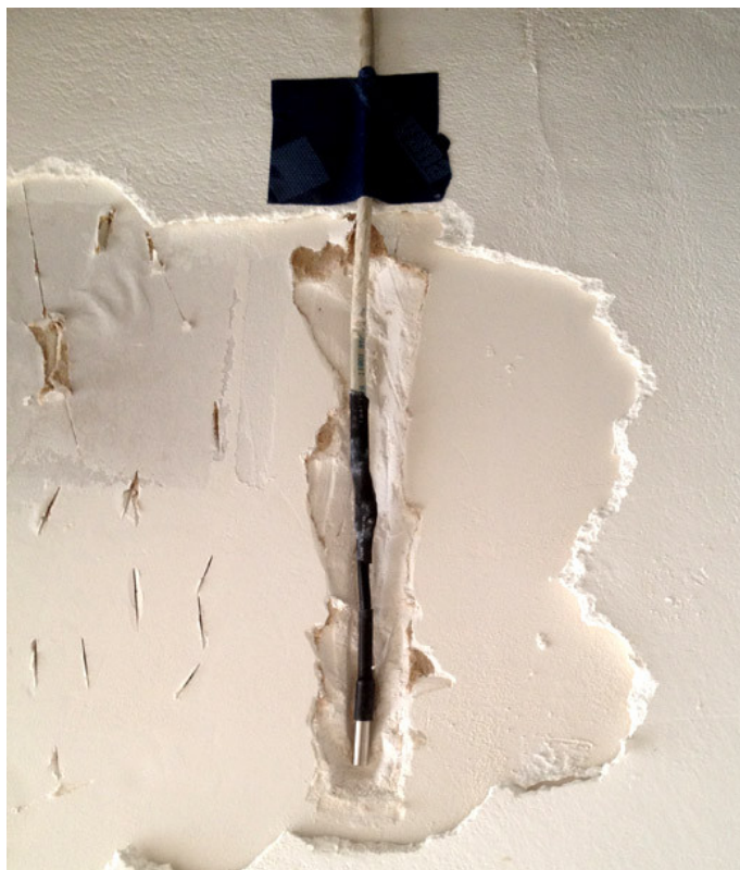
Pose de la sonde de température dans l'enduit. © Hinoki
