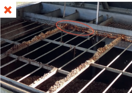
Une partie du combustible, de couleur plus foncée et entourée en rouge sur la photo, est gorgée d'eau. L'ensemble de la livraison n'est pas homogène en termes de taux d'humidité. ©AQC
