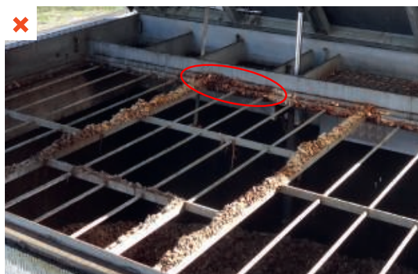
Une partie du combustible, de couleur plus foncée et entourée en rouge sur la photo, est gorgée d'eau. L'ensemble de la livraison n'est pas homogène en termes de taux d'humidité.
