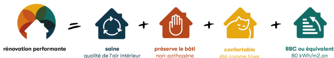
Figure 4 : Définition de la rénovation performante. Source : Dorémi.
