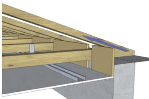
Figure 32 : Mise en place de déflecteurs. Source : CPT 3693 (CSTB)
