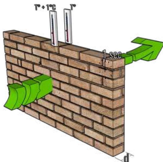
Figure 9: Conductance d'un matériau (Source : Cluster Eco-construction)
