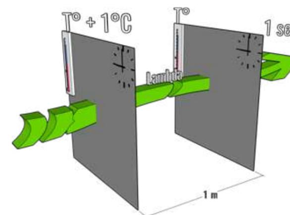
Figure 8: Conductivité thermique d'un matériau (Source : Cluster Eco-construction)
