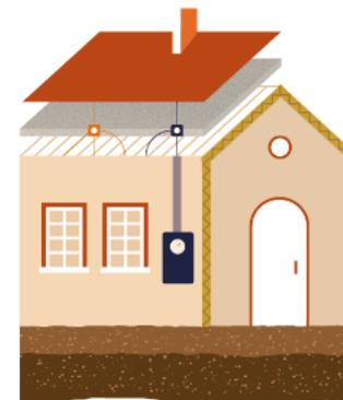
**MURS** (avant : Mur panneaux béton contreventés) ITE en fibre de bois enduite ép. 200mm R=5,1 ITE en fibre de bois bardage ép. 222mm R=5,85 ITI en laine de bois sur mur ss-sol ép. 160mm R=4,4
